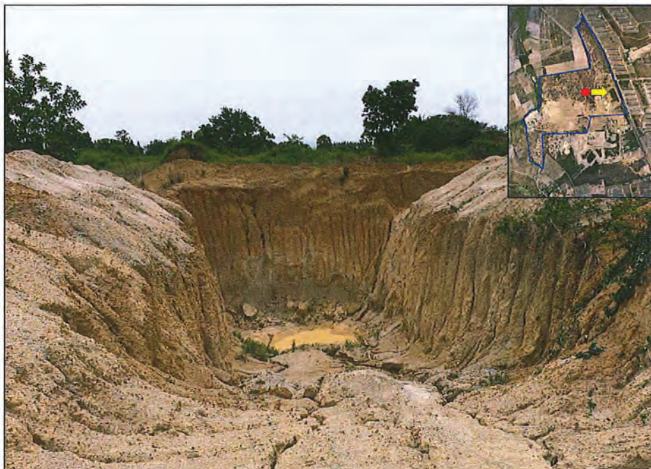
รูปที่ 2.4 ภาพถ่ายแสดงตัวอย่างชั้นเปลือกดิน (Topsoil) และชั้นแกรนิตผุ (Weathered Granite) ตำแหน่งพิกัด 741980 E, 1458116 N ถ่ายไปทางด้านทิศตะวันออก บริเวณบ่อขุดทรายในพื้นที่คำขอประทานบัตร
