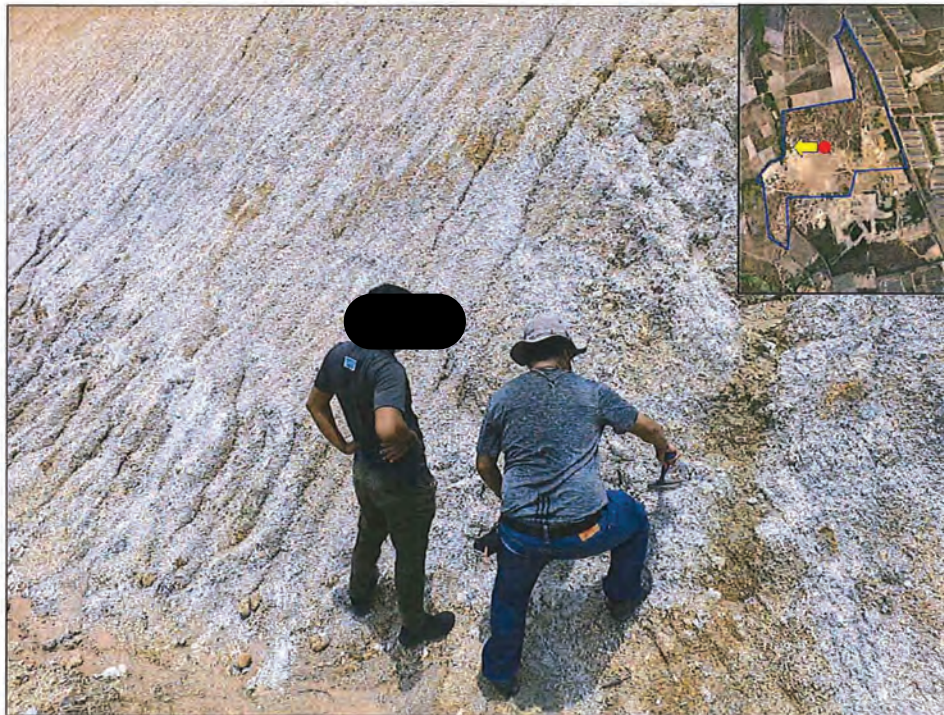
รูปที่ 2.6 ภาพถ่ายแสดงตัวอย่างชั้นแกรนิตผุ (Weathered Granite) ตำแหน่งพิกัด 741881 E, 1457964 N ถ่ายไปทางด้านทิศตะวันตก บริเวณบ่อขุดทรายในพื้นที่คำขอประทานบัตร
