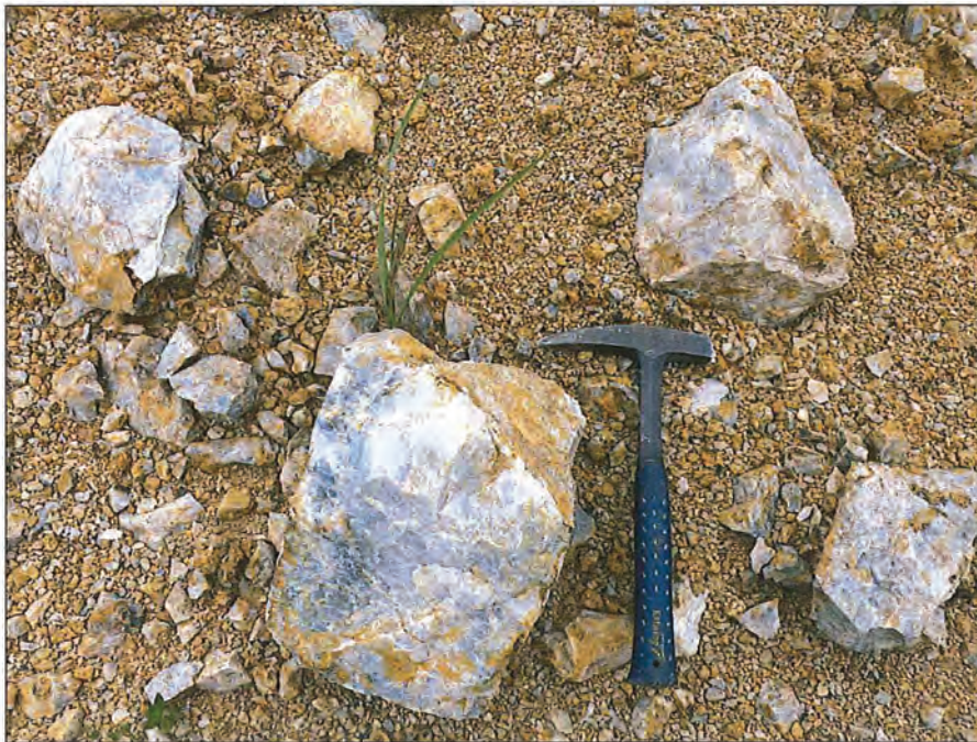
รูปที่ 2.10 ภาพถ่ายแสดงตัวอย่าง Float granite หินแกรนิตสด (Fresh Granite) ตำแหน่งพิกัด 741916 E, 1457901 N ในบริเวณพื้นที่คำขอประทานบัตร
