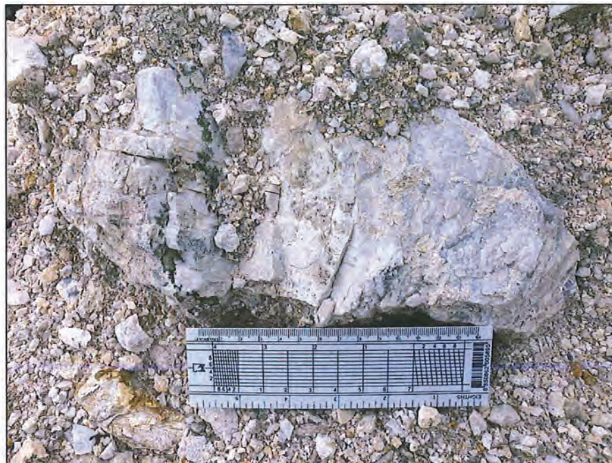
รูปที่ 2.11 ภาพถ่ายแสดงตัวอย่าง Float granite หินแกรนิตสด (Fresh Granite ) ตำแหน่งพิกัด 741849 E, 1457654 N ในบริเวณพื้นที่คำขอประทานบัตร
