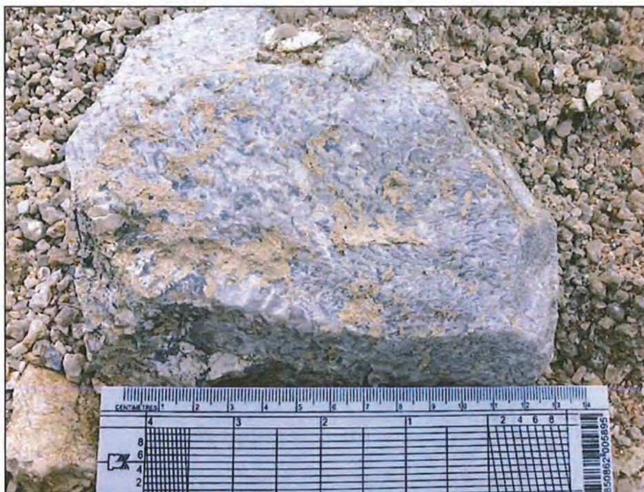
รูปที่ 2.9 ภาพถ่ายแสดงตัวอย่าง Float granite หินแกรนิตสด (Fresh Granite) ตำแหน่งพิกัด 741980 E, 1458116 N ในบริเวณพื้นที่คำขอประทานบัตร
